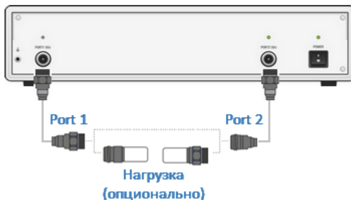
Рисунок 14 – Калибровка нормализации передачи
