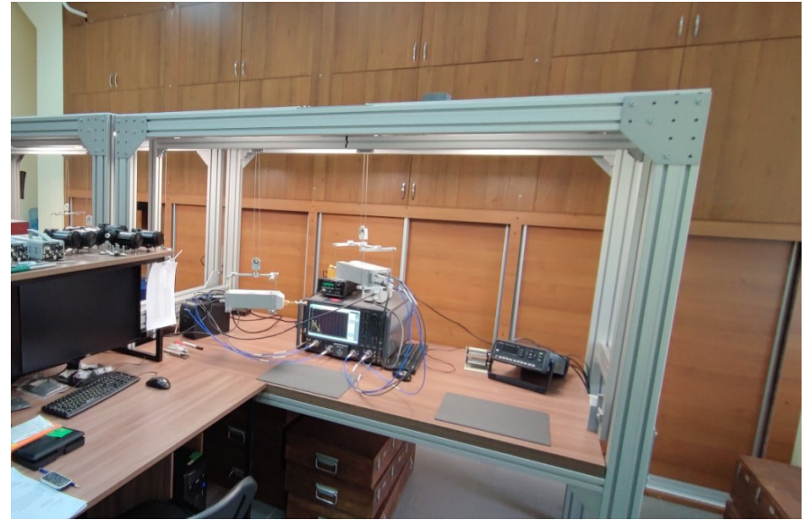
Установка компарирующая волноводная в диапазоне частот от 37,5 до 178,4 ГГц
