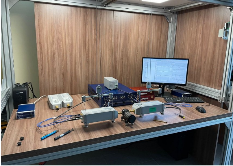
Установка компарирующая волноводная в диапазоне частот от 2,14 до 37,5 ГГц
