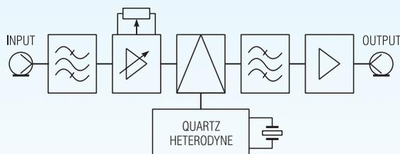
Конвертор предназначен для конвертации одного канала ДМВ диапазона в другой канал МВ диапазона. Он изготавливается на фиксированные каналы под заказ и предназначен для использования в небольших распределительных сетях кабельного телевидения (дом, коттедж).
