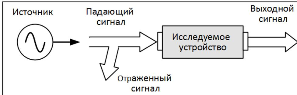
Рисунок 4.1 Распространение сигнала по измерительной цепи. Измерения амплитуды и фазы падающего, отражённого и выходного сигналов позволяют получить S–параметры исследуемого устройства (параметры рассеяния). S–параметры определяются как отношение комплексных амплитуд двух волн:
