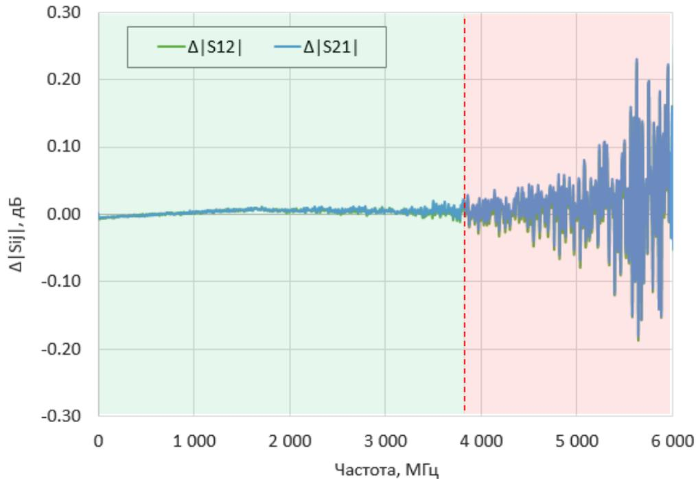
Рисунок 5.12 Отклонение коэффициента передачи  $\Delta|S_{ij}| = |S_{ii}^{ACMB} - S_{ii}^{BAЦ}|$
