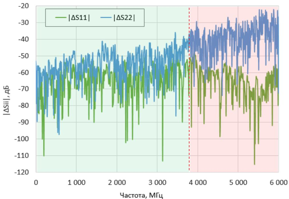
Рисунок 5.11 Отклонение коэффициента передачи  $|\Delta S_{ii}| = 20 \lg |S_{ii}^{ACMB} - S_{ii}^{BAЦ}|$
