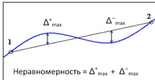
Рисунок 6.10 Пример определения неравномерности
