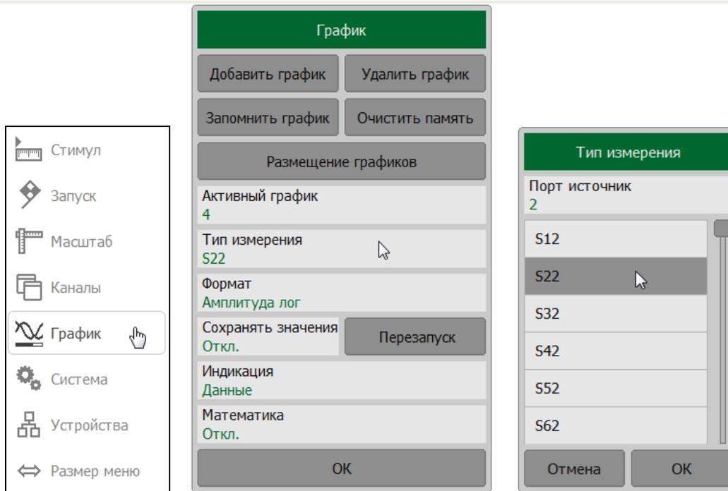
Для быстрой установки измеряемого параметра щёлкните мышью по названию измеряемого S–параметра в строке состояния графика. В открывшемся окне выберите строку с требуемым параметром.
