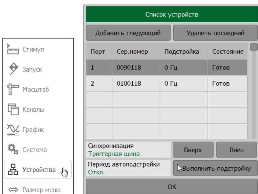
После выполнения подстройки в окне **Список устройств** в поле **Подстройка** будет показана величина коррекции частоты опорного генератора второго рефлектометра.
