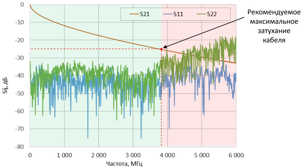
Рисунок 5.10 Коэффициенты передачи и отражения  $S_{11}^{ACMB}$ ,  $S_{21}^{ACMB}$ ,  $S_{22}^{ACMB}$
