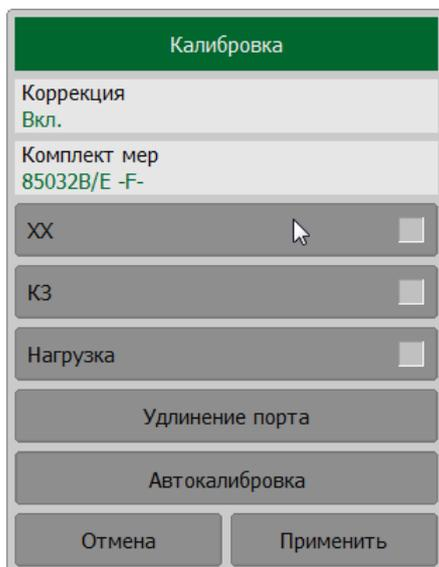
3 В окне канала рефлектометра во время измерения откроется окно с индикацией процесса выполнения калибровки. По завершению измерения в правой части кнопки с обозначением меры **КЗ**, **XX**, **Нагрузка** появится цветовая индикация.
