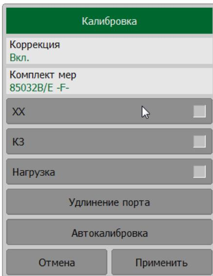
3 В окне канала рефлектометра во время измерения откроется окно с индикацией процесса выполнения калибровки. По завершению измерения в правой части кнопки с обозначением меры **XX** или **КЗ** появится цветовая индикация.
