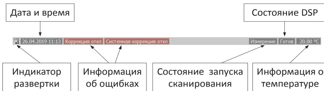
Рисунок 2.3 Строка состояния измерителя
