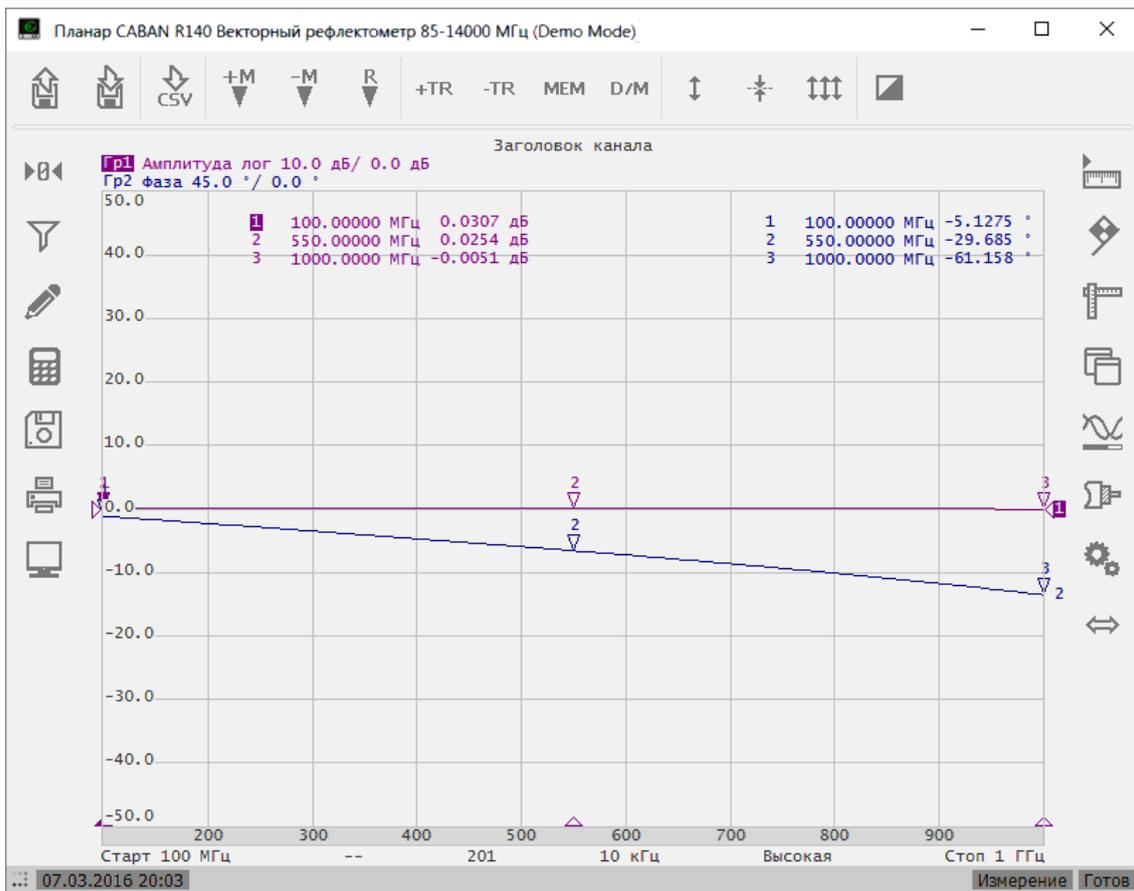
Рисунок 3.3 Пример измерения КСВН и фазы коэффициента отражения
