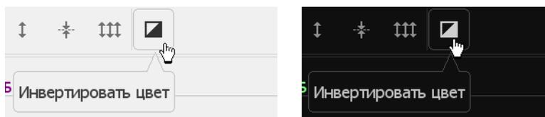
Нажмите программную кнопку **Индикация**. Щелкните по полю **Инвертировать цвет** для включения и выключения функции инвертирования.
