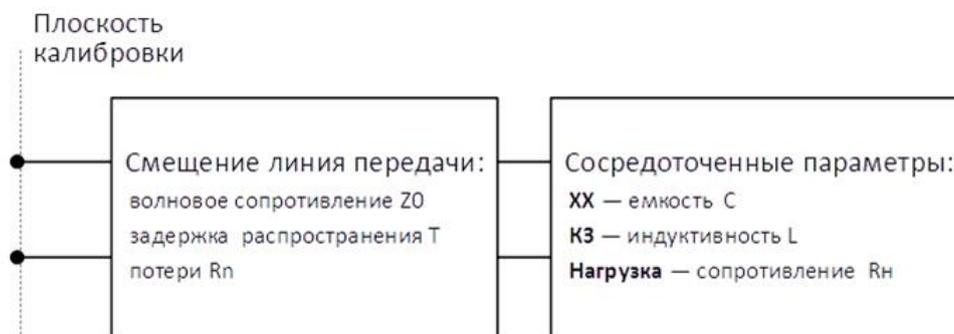
Рисунок 5.3 Модель однопортовой меры
