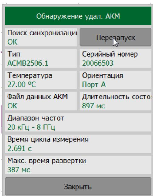
При необходимости обновления идентификационными данными АКМ используйте кнопку **Перезапуск**.
