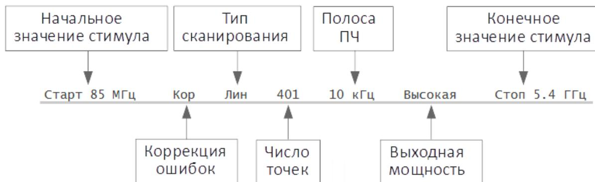
Рисунок 2.7 Пример строки состояния канала
