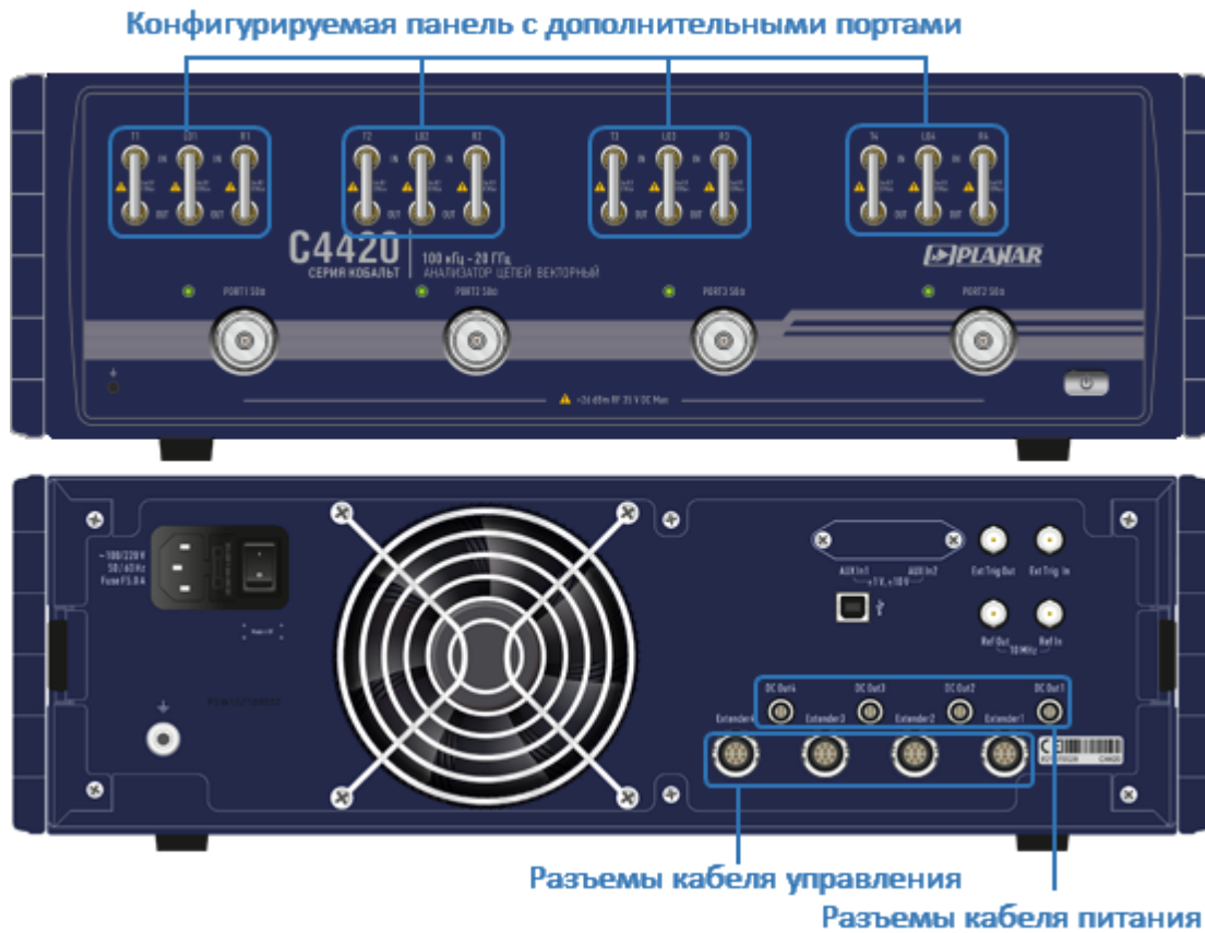
Рисунок 209 – Расположение дополнительных разъемов анализатора C4420
