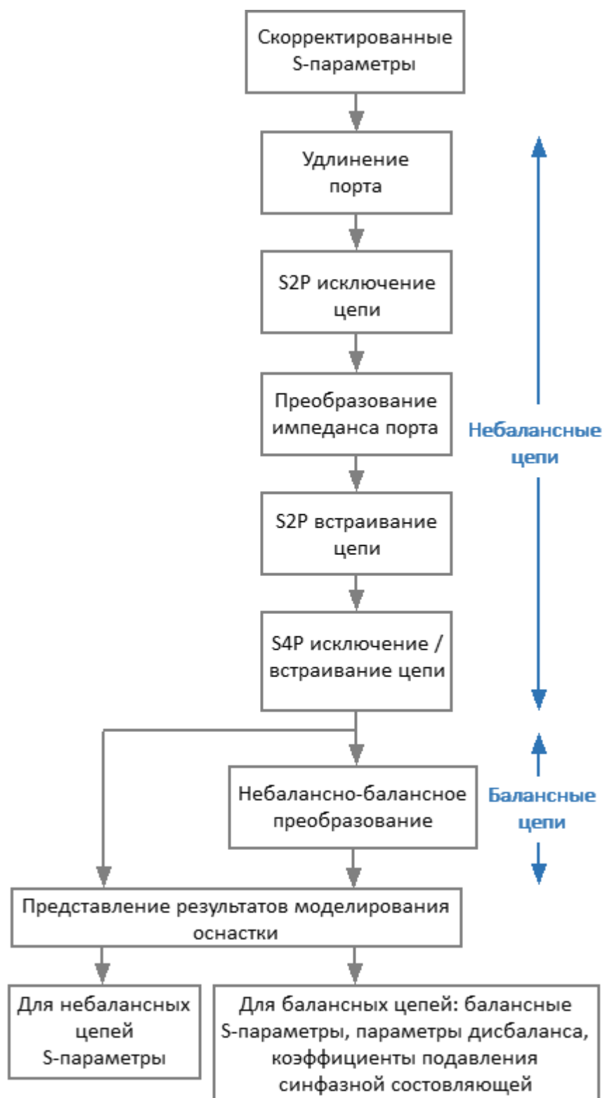
Рисунок 177 – Блок-схема обработки данных при моделировании оснастки
