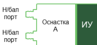
Рисунок 46 – Двухпортовая измерительная установка оснастки на примере портов 1 и 2
