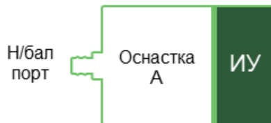
Рисунок 44 – Однопортовая измерительная установка оснастки на примере порта 1
