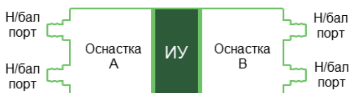
Рисунок 48 – Четырехпортовая измерительная установка оснастки
